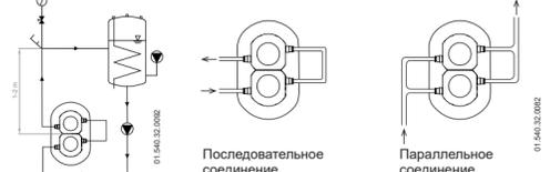
Вспомогательная жидкость для торцевых уплотнений должна всегда циркулировать при функционировании насоса. Ответственность за выбор вспомогательной жидкости всегда несет конечный пользователь. INOXPA не несет ответственности за выбор вспомогательной жидкости.
